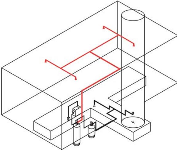
Casetas Rociadoras de Pintura “Tamaño Extra” –El **“IS”** de Amerex es el primero Certificado por UL que permite que las boquillas se coloquen hasta 23’-4” sobre el suelo –ahora usted puede proteger una Caseta Rociadora de Pintura para Vehículos grande, la cual se emplea para camionetas y equipo pesado, con un Sistema completamente Certificado por UL que ha sido específicamente probado para esta aplicación con incendios reales.
